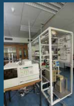
MAT – test mikro aktivnosti FCC katalizatora
