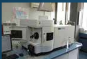
ICP-OES spektrofotometar – metali i kationi u vodama, eluatima otpada i razgrađenim uzorcima
