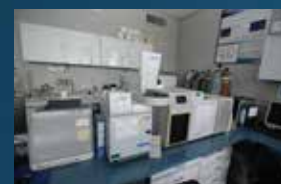
Vezani sustav plinski kromatograf/spektrometar masa (GC/MS) – snimanje kromatograma (ukupne ionske struje)
