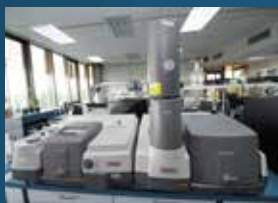
FTIR/Raman spektrofotometar – FAME u dizelskom gorivu, benzen u benzinu; identifikacija nepoznatih uzoraka
