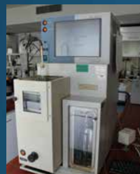
Jedinica za destilaciju - ispitivanje destilacijskih karakteristika naftnih proizvoda
