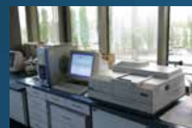
UV/VIS spektrofotometar – anionski i kationski detergentsi; divalentno željezo; određivanje biljci pristupačnog fosfora iz tla
