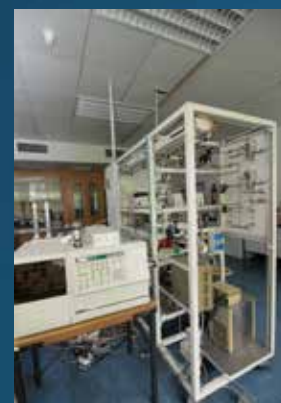
MAT – test mikro aktivnosti FCC katalizatora
