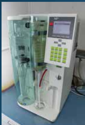
Destilacijska jedinica – destilacija uzoraka voda, nafta i naftnih frakcija nakon razgradnje s ciljem određivanja sadržaja Kjeldah dušika
