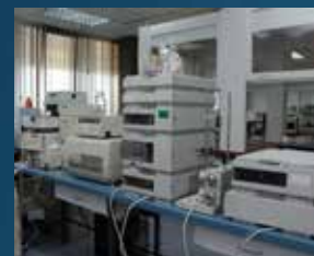
Tekućinski kromatograf (HPLC) – aromatski ugljikovodici u srednjim naftnim frakcijama; Euromarker SY 124
