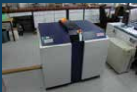
Valno-disperzivni rendgenski fluorescentni spektrometar – sumpor u nafti i naftnim proizvodima, klor, olovo, vanadij, nikal; skeniranje krutih i tekućih uzoraka na prisustvo metala
